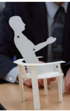
サイズを計測し、手足が曲がる5分の1サイズの人体型紙を作ります。それを使って、座るのに最適な座面の高さや肘掛の位置などを決めて、図面を描きます。その図面をもとにスチレンボード製の5分の1サイズの椅子模型を作ります。大切なのは小さいながらも立体的な椅子を作り、デザイン、バランスなどを確認すること。建築家が建物の模型を作り、プレゼンテーションをするように、平面では気がつかなかった座り心地、使いやすさが立体模型ならよく理解できます。そして背もたれの角度や足の位置など、調整すべき点は直して、次に2分の1の図面を描きます。最後は実習室で電動ノコギリなどの工具を使って、木製の椅子を完成させます。
